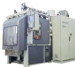
Foto 3: soffiatrice PB5000/CF a trasferimento di parison
