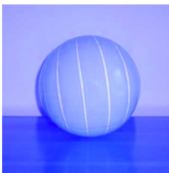
Foto 1: palla senza foro realizzata su soffiatrice PB5000/CF
