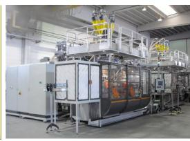
Le soffiatrici Plastiblow ad azionamento elettrico risultano particolarmente indicate per la produzione di flaconi nel settore alimentare, in quanto la totale assenza di attuazioni idrauliche previene ogni contaminazione dei prodotti e dell'ambiente e consente l'utilizzo della macchina nei locali sterili o ad atmosfera controllata, come spesso è richiesto nelle aziende alimentari per prevenire la formazione di colonie batteriologiche.
